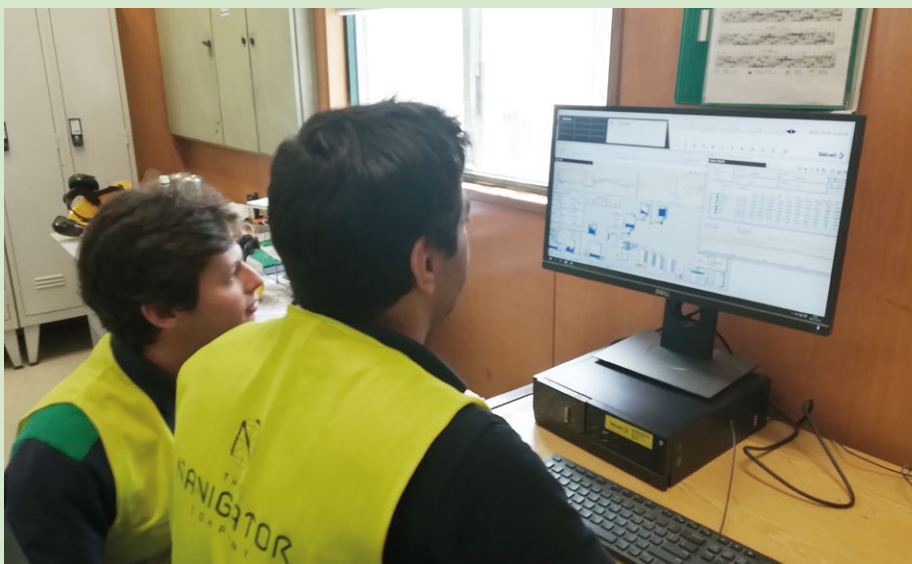
Os controles e a interface de operação se baseiam no Valmet DNA, conectados ao SDCD (sistema digital de controle distribuído) existente.
