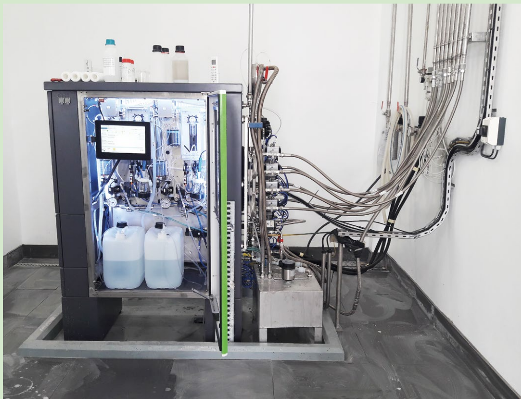
O analisador de licor, Valmet Alkali R, coleta amostras em seis pontos.
